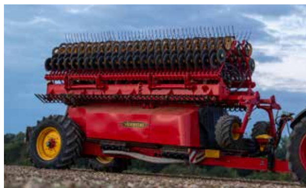
W pozycji złożonej Inspire 1200C/S ma szerokość 3 metrów, co ułatwia transport.
