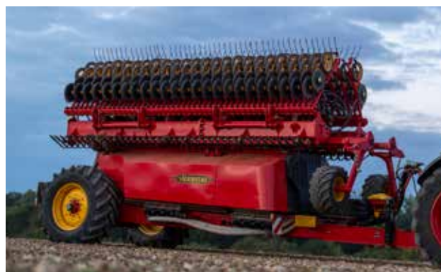
Tăvălugul din pneuri frontal consolidează solul între roțile tractorului asigurând astfel aceleași condiții de germinare pe toată lățimea de lucru.
